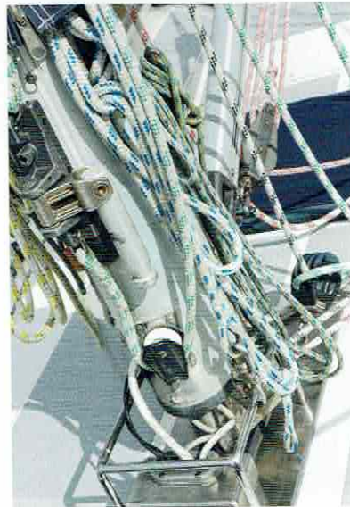
Das Rigg steht an Deck in einem kleinen Edelstahlkäfig, der die Kabel schützen soll.
