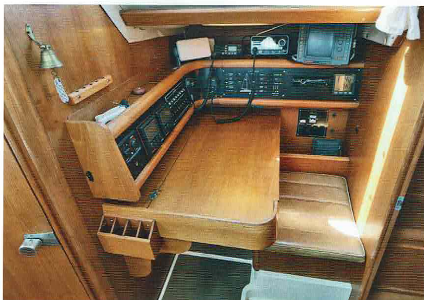
Die Navigation ist in Fahrtrichtung ausgerichtet und lässt sich auch bei Lage gut nutzen, ein „Dashboard“ dient zur Aufnahme zusätzlicher Elektronik. Im Sitz findet sich zusätzlicher Stauraum.
