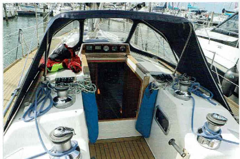
Der Niedergang ist weit nach vorn gezogen, dies macht ihn sehr sicher und erleichtert die Arbeit an den Winschen bei Lage, die Sprayhood stört dabei kaum, ist aber sehr hoch ausgefallen.
