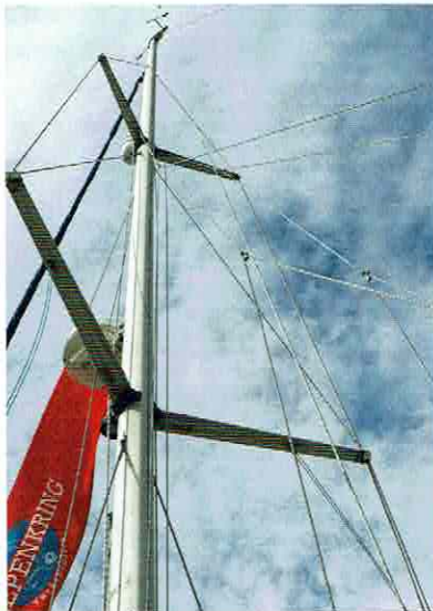
Das verjüngte 7/8-Rigg verfügt über zwei stark gepfeilte Salingpaare und ist sehr gut zu trimmen.
