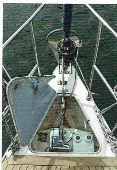
Ein großer Anker- und Kettenkasten lässt auch die verdeckte Montage der Ankerwinch zu.
