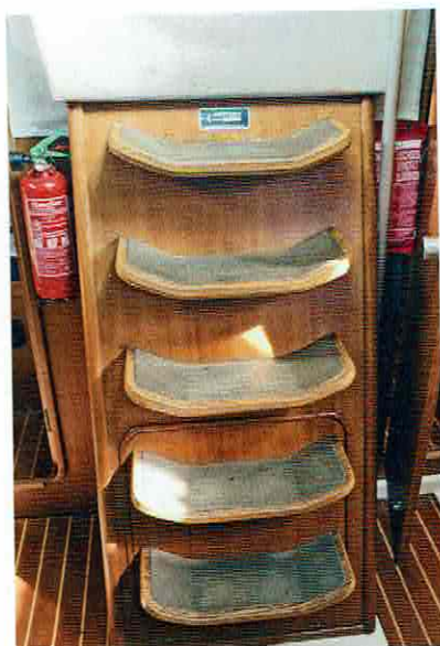
Der Niedergang ist tief und recht steil, gewinkelte Stufen machen ihn dennoch trittsicher.
