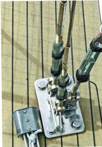
Das Rigg ist solide verankert, viele Beschläge wurden bereits durch modernere ersetzt.
