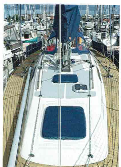
Der nachgerüstete Permateek-Deckbelag macht auch nach sieben Jahren einen guten Eindruck.
