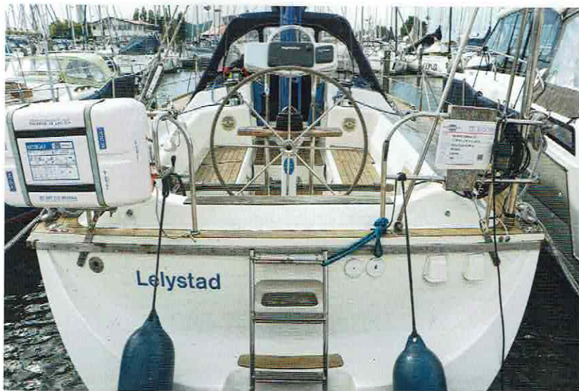
Die Westerly verfügt über ein moderat breites Heck, durch die schmale, eingeformte Badeplattform wirkt die Konstruktion überraschend modern. Eine Rettungsleiter gehört zum Standard.
