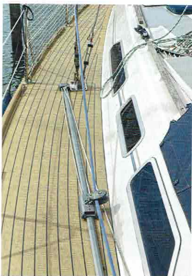
Breite Seitendecks und weit innen montierte Püttinge erleichtern den Weg auf das Vorschiff.
