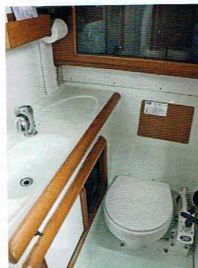
Das Bad achtern verfügt über einen großen Waschtisch, die Armatur lässt sich zum Duschen herausziehen.
